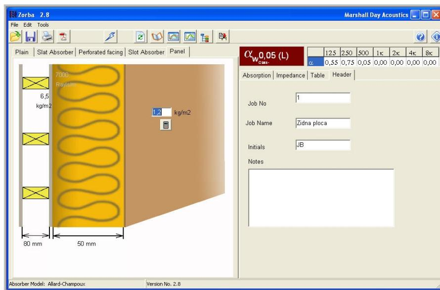
Prilikom optimizacije akustike prostora, često se ukaže potreba za materijalom za unutarnje uređenje čije akustičke osobine ne odgovaraju niti jednom tržišno dobavlјivom materijalu, stoga je potrebno isprojektirati materijal koji će odgovarati traženim akustičkim osobinama. U takvim slučajevima se koristi programski paket Zorba, čije opcije projektiranja materijala omogućuju učinkovita i prilagodljiva rješenja, za svaki postavljeni projektni zadatok.
