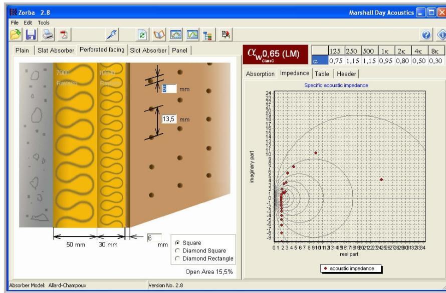
Izračunom se, prema 9 mogućih teoretskih modela, određuje akustička impedancija, koeficijent gušenja zvučne energije, te koeficijent prigušenja zvuka za okomiti i slučajni upad zvučne energije.
