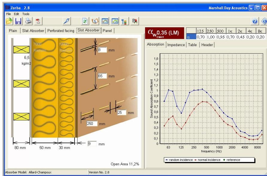
Rezultate izračuna je moguće prikazati u tabličnom ili grafičkom obliku, a mogućnosti izračuna apsorpcije zvuka obuhvaćaju gotovo sve praktično izvedive tipove perforacija zidnih obloga. Pri izračunu je moguće odabratи vrstu podloge, tip i količinu ispune, te pet osnovnih modela obloga.
